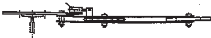
Fig. 3 tendeur avec contrepooids (doté d'interrupteur de sécurité présent uniquement dans les installations conformes à la norme EN 81) Mod. LK 200/250/300/315/200T Avec commande à distance
