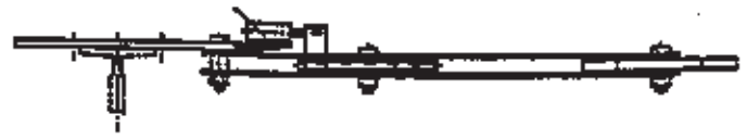
Fig. 3 tenditore con contrappeso interruttore di sicurezza solo negli impianti conf. all'EN 81 Mod. LK 200/250/300/315/200T con comando a distanza
