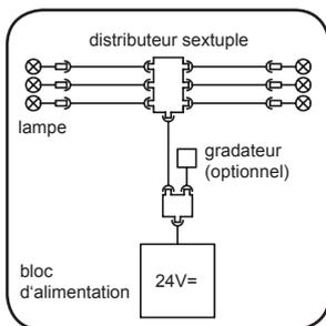
Veuillez prévoir à une position appropriée dans le plafond de la cabine un caniveau de câbles de 12mm pour la conduite entre le distributeur sextuple et le bloc d'alimentation vers le toit de la cabine. Utilisez pour cela le caniveau de caoutchouc ci-joint. Le bloc d'alimentation ne devrait pas être placé dans le plafond de la cabine.
