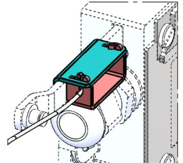
Alternative Befestigung auf der Verbindungsstange (Zubehör - bitte separat bestellen) /
